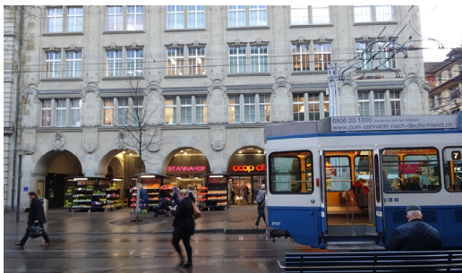
▲歩行者の物理的・心理的安全性確保と輸送量の両立がコンセプトになっています。トラム（ライトレール）の平均運行速度が約18～22 km/hに設定されており、市街地での運行が主体なので、歩行者や信号、停留所の多さを考慮した速度設定となっています。
